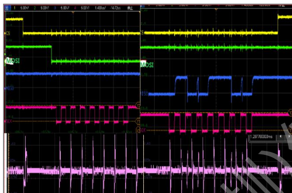
SPI 信号和隔离 SPI 脉冲, MSTR=1
