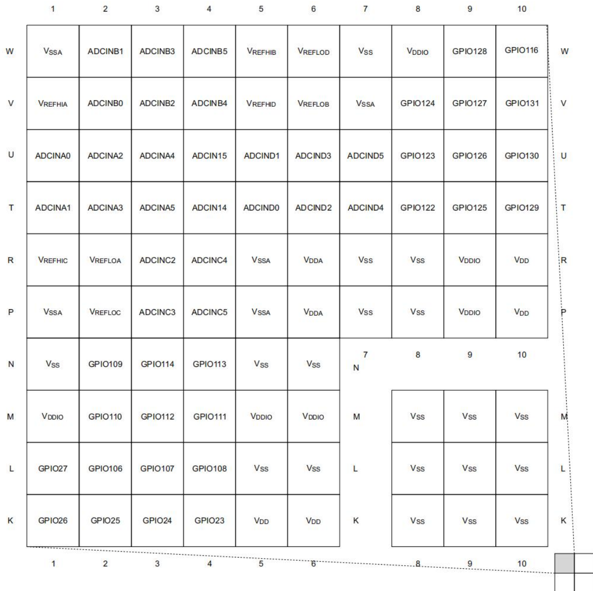
图 5-1.337 焊球全新细间距球栅阵列（底视图）-[象限 A]
